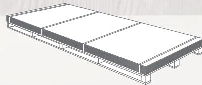
*Die Slim Line Platten müssen waagrecht auf einem geraden, stabilen Untergrund gestapelt werden. Um die Oberfläche zu schützen, muss die Abdeckplatte oben auf dem Stapel aufliegen. Falsche Lagerung kann zu bleibenden Plattenschäden führen.*
